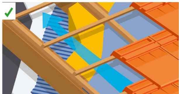
Lorsqu'un écran de sous-toiture hautement perméable à la vapeur d'eau (HPV) est présent, une lame d'air est conservée uniquement entre l'écran de sous-toiture, très ouvert à la vapeur d'eau, et les éléments de couverture. L'isolant peut venir au contact de l'écran HPV. À l'intérieur, l'ouverture à la diffusion de la vapeur d'eau (Sd) du plan d'étanchéité à l'air, sera choisie en fonction de la nature de l'isolant et du Sd de l'écran de sous-toiture. ©AQC
