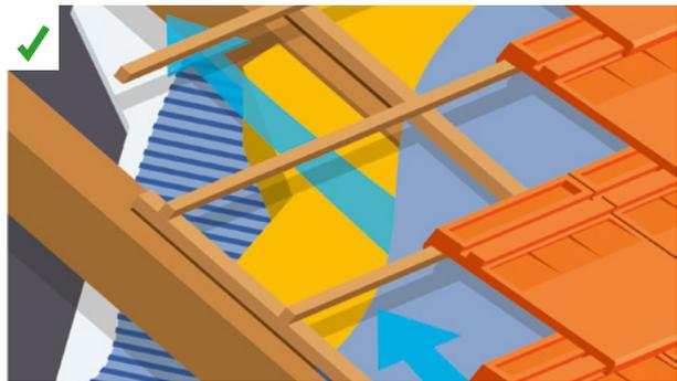
Lorsqu'un écran de sous-toiture non ouvert à la vapeur d'eau est présent, une lame d'air ventilée de 2 cm minimum doit être conservée entre la couverture et l'écran de sous-toiture d'une part et entre l'écran de sous-toiture et l'isolant d'autre part. ©AQC
