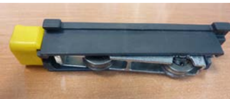
Chariot de châssis coulissant résistant mal aux charges appliquées (Crédit photo: Saretec)
