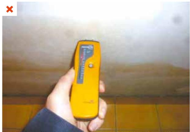
Humidité importante en pied de mur du fait d'une fuite de canalisation. ©AQC-2016
