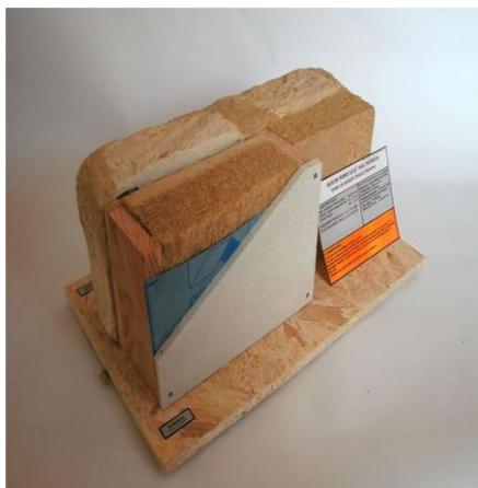
Cinq coupes de murs présentant des techniques de construction et d'isolation en neuf et en rénovation : mur à ossature bois et bottes de paille, mur à ossature bois et ouate de cellulose, mur isolé par l'extérieur avec panneaux enduits, mur isolé par l'extérieur sous bardage bois, mur en pierre isolé par l'intérieur.
