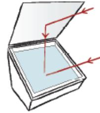
Il s'agit d'une boîte en bois isolée, fermée par un couvercle en verre. Son fonctionnement est simple, c'est celui de l'effet de serre : le rayonnement solaire traverse le vitrage et il est absorbé par les parois peintes en noir. Cette boîte étanche va permettre une montée en température de 120 à 150°C.
